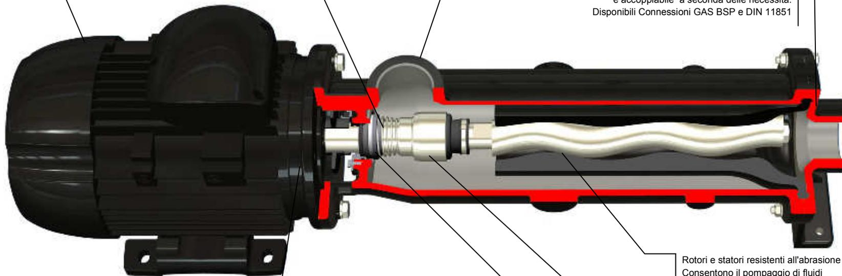
Rotori e statori resistenti all'abrasione Consentono il pompaggio di fluidi molto viscosi e con parti solide in sospensione. Il rotore può essere fornito in diversi materiali base e trattato termicamente o rivestito per aumentarne la durata. Gli statori possono essere configurati con vari tipi di elastomeri
