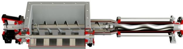
Versión dotée d'une trémie et de vis d'Archimède d'alimentation vers la partie hydraulique, idéale pour le transport de produits qui s'écoulent mal qui ont tendance à former des ponts. Réalisée de série en acier inoxydable AISI 304 ou AISI 316.
