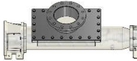
“B” Modul Brückenbrecher: Dieses Modul kann auf Trichter gesetzt werden, es verfügt über ein innenliegendes Rad, welches die Trichterwände frei räumt und die Brückenbildung über der Zuführschnecke verhindert. So können auch klebende Produkte, mit bis zu 40% Trockensubstanz, gefördert werden.
