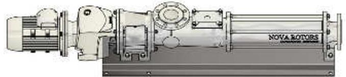
Grundplatte gemäß API 676. Die Anforderungen der API 676 beinhalten Leckage-Auffang-Wannen oder Rinnen, Vergussöffnungen, Trageösen, Erdungsanschlüsse, Nivellierschrauben, Justierschrauben für die Ausrichtung des Antriebs und vieles mehr.
