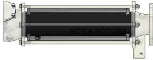
**Pumpengehäuse mit Heizmantel:** Der Heizmantel kann mit heißer Flüssigkeit beschickt werden, um das Pumpengehäuse vorzuheizen. Dies ist bei gewissen Produkten notwendig, die sich unter einer bestimmten Temperatur noch im festen Aggregatzustand befinden (z.B. Schokolade, Bitumen) und somit nicht pump-fähig wären.
