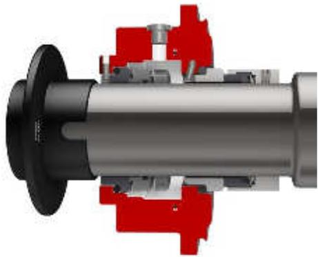
**Gleitringdichtung, doppelwirkend, Tandem K0K9**
