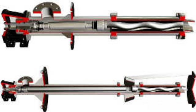
Serie Verticale sviluppata per il pompaggio da cisterne o pozzi immersa direttamente nel prodotto da pompare. La lunghezza è totalmente customizzabile. La versione in acciaio inossidabile (AISI 304 o AISI 316) presenta una camicia copri statore di serie per evitarne la corrosione. Esistono due configurazioni standard: in versione corta e in versione lunga con imbocco smontabile e cavalletto fondo pozzo.
