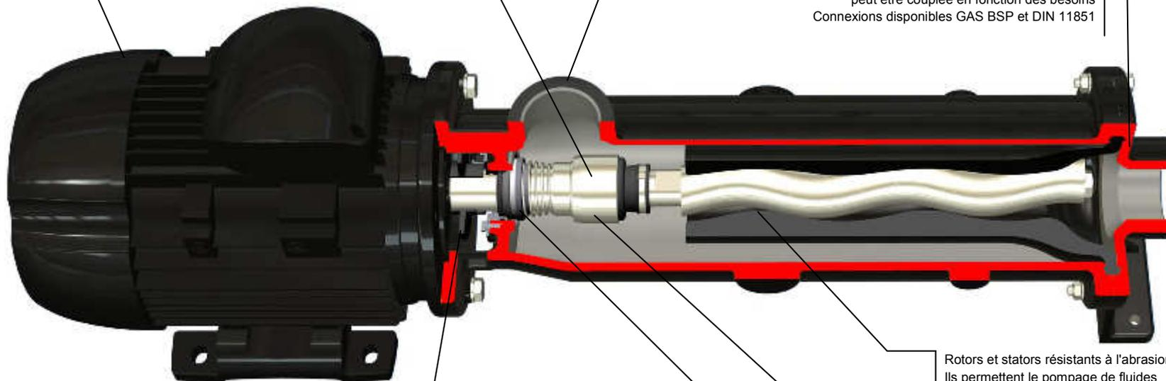
Rotors et stators résistants à l'abrasion. Ils permettent le pompage de fluides très visqueux et avec des parties solides en suspension. Le rotor peut être fourni dans différents matériaux de base et traité thermiquement ou revêtu pour en augmenter la durée. Les stators peuvent être configurés avec différents types d'élastomères
