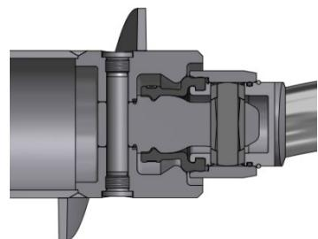
**Modulbauweise:** Die Diamond Baureihe basiert auf der Modulbauweise, die sich in jeder Komponente wiederfindet: die hydraulischen Komponenten, Gehäuse, Dichtungen, Grundplatten, Laternen und Antriebswellen. Jedes Teil kann in verschiedenen Varianten gefertigt werden, ohne den Aufbau der Pumpe zu ändern, wobei die Haupt-Ersatzteile Standardartikel bleiben, was sich positiv auf Verfügbarkeit und wettbewerbsfähige Preise auswirkt.
