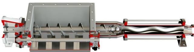
Trichterpumpe mit erweitertem Einlauftrichter und Zuführschnecke, zusätzlich seitlich liegender Paddelwelle, geeignet für schwer fließfähige Schlämme, die zur Brückenbildung neigen. Standardmaterial: Edelstahl AISI 304 oder AISI 316.
