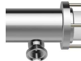
CIP-Anschluss im Pumpengehäuse integriert. Diese Option ermöglicht das Einleiten von Reinigungsflüssigkeit direkt in das Pumpengehäuse, um hygienische Pumpen optimal zu reinigen. Tangential zum Gehäuse gefertigt, verhindert sie Stagnation und sorgt für eine effiziente Entleerung der Flüssigkeiten.
