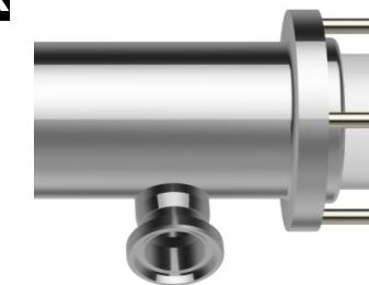
CIP-Anschluss im Pumpengehäuse integriert. Diese Option ermöglicht das Einleiten von Reinigungsflüssigkeit direkt in das Pumpengehäuse, um hygienische Pumpen optimal zu reinigen. Tangential zum Gehäuse gefertigt, verhindert sie Stagnation und ermöglicht eine effiziente Entleerung der Flüssigkeiten.
