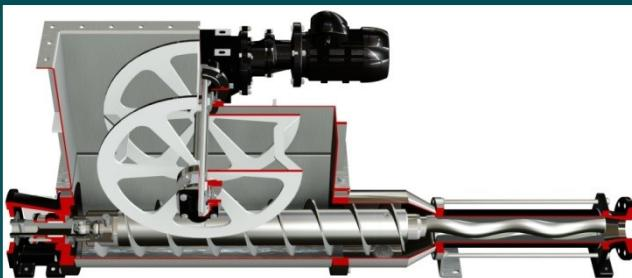
Standard Trichterpumpe mit integriertem Manschettenschutz und großer Zuführschnecke, zusätzlich das aufgesetzte "B" Modul ideal zur Förderung von nicht fließfähigen, zu Brückenbildung neigenden, klebrigen Schlämme mit einem Trockenstoffgehalt von bis zu 40%.
