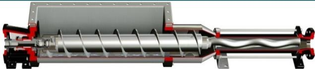
Trichterpumpe mit integriertem Gelenkschutz, großen Einlauftrichter und großer Zuführschnecke, geeignet zur Förderung von kaum fließfähigen, leicht zu Brückenbildung neigenden Schlamm mit bis zu 28% Trockenstoffgehalt.
