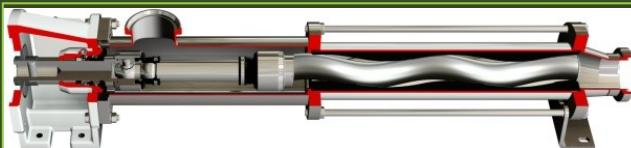
Robuste Industriepumpe mit Flanschen oder Schraub-Anschlüsse, entworfen für ein breites Spektrum von Anwendungen. Verfügbare Anschlussvarianten: DIN, ANSI, UNI, GAS BSP Gewinde.
