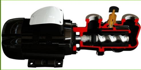
Die R Baureihe ist eine äußerst kompakte Wobbelpumpe, die aufgrund der geringen Baugröße mit einem Kreuzgelenk ausgerüstet ist. Der Verzicht auf die Laterne zwischen Pumpe und Motor reduziert die Abmessungen zusätzlich.
