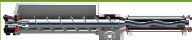
Trichterpumpe mit rechteckigem Einlauftrichter, großer Zuführschnecke, integriertem Gelenkschutz, Gülle-Injektions-Anschluss zur Vermischung der Silage mit Flüssiggülle, und einem Steinfang mit großer Öffnungsklappe plus zusätzlicher oben gelegener Inspektionsklappe.
