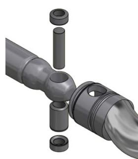
**Mantenimiento:** la serie Diamond está diseñada para garantizar un mantenimiento fácil, requiriendo la sustitución de un número mínimo de componentes. En particular, los casquillos de la articulación permiten su restauración completa sin necesidad de reemplazar ejes o rotores. De este modo, los costos de mantenimiento se reducen considerablemente. El costo de la máquina, considerando todo su ciclo de vida, resulta altamente competitivo.
