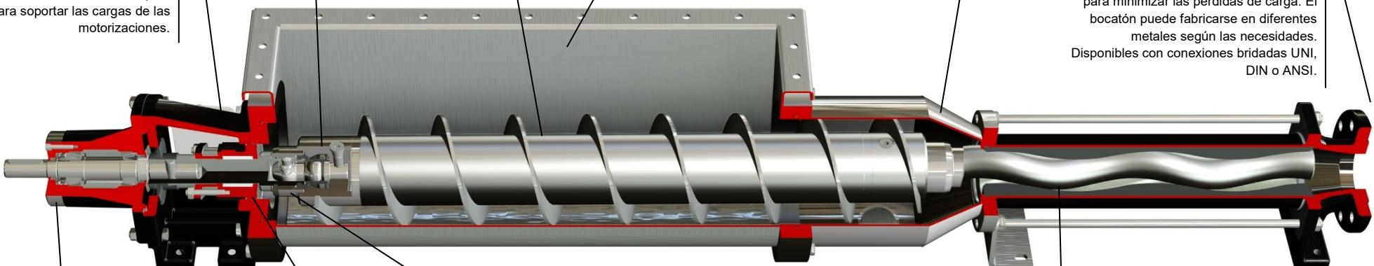
Tolva rectangular personalizable en longitud. Puede fabricarse en diferentes aleaciones según las necesidades. Se construye con espesores elevados para garantizar una resistencia extrema.
