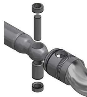
**Mantenimiento:** la serie Diamond está diseñada para garantizar un mantenimiento sencillo, necesitando la sustitución de un número mínimo de componentes. En particular, los casquillos de la articulación permiten la restauración total de la misma sin necesidad de reemplazar ejes y rotores. De este modo, los costes de mantenimiento se reducen considerablemente. El costo de la máquina, considerado a lo largo de todo su ciclo de vida, resulta altamente competitivo.
