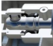
Protección del acoplamiento integrada en el extremo del tornillo sinfín. Fundamental para el bombeo de fluidos abrasivos o que contienen sólidos contundentes. Garantiza un notable aumento de la fiabilidad del acoplamiento.
