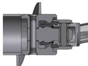
**Modularidad:** la serie Diamond se basa en el concepto de modularidad en cada una de sus características: partes hidráulicas, carcasa, sellos, bases, soportes, árboles de transmisión. Cada componente puede fabricarse en una serie de variantes sin modificar la estructura de la máquina, manteniendo como estándar los principales componentes de repuesto.
