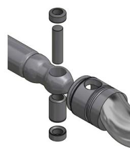
**Mantenimiento:** la serie Diamond está diseñada para garantizar un mantenimiento fácil, requiriendo la sustitución de un número mínimo de componentes. En particular, las bujes del acoplamiento permiten la restauración total del mismo sin necesidad de reemplazar árboles y rotores. De este modo, los costos de mantenimiento son reducidos. El costo de la máquina, considerado en su ciclo de vida completo, es altamente competitivo.
