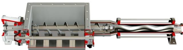
Versión dotada de tolva ancha y cóclea de alimentación de la parte hidráulica, ideal para el transporte de productos poco fluidos que tienden a formar puentes. Realizada de serie con acero inoxidable AISI 304 o AISI 316.
