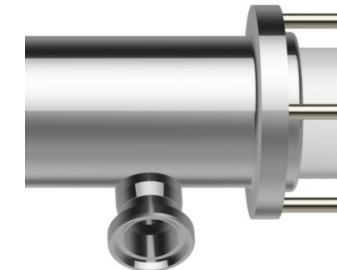
Conexión CIP realizada en el cuerpo de la bomba. Esta opción permite introducir el fluido de lavado en el cuerpo de la bomba para limpiarla de la mejor manera en entornos sanitarios. Al estar realizada en tangencia con el cuerpo, evita estancamientos, permitiendo un drenaje eficaz.
