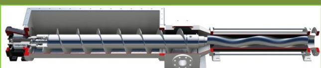
Versión de tolva rectangular, con protección de las articulaciones y cóclea ancha de alimentación de la parte hidráulica realizada para el sector del biogás para bombear ensilaje. La boca separada presenta la inyección y un fondo rectangular para recoger piedras y otros cuerpos extraños que pueden entrar en la tolva con un amplio registro de inspección adicional.
