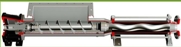
Versión básica dotada de tolva y cóclea de alimentación de la parte hidráulica. Apropiada para bombear sustancias poco fluidas que no tienden a formar puentes.
