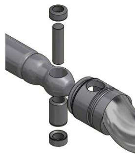
**Maintenance :** La série Diamond est conçue pour garantir une maintenance facile en réduisant au minimum le nombre de composantes à remplacer. En particulier, les douilles de l'articulation permettent la remise en état de celle-ci sans devoir remplacer les arbres et les rotors. Les coûts de maintenance sont ainsi réduits. Le coût de la machine, si l'on considère l'ensemble de sa vie, s'avère être très compétitif.
