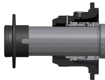
**Protection du joint :** Dans la série DHSB e JHSB le manchon de couplage et la bride sont protégés par une composante intégrée notamment aux extrémités de la vis d'Archimède. Cette caractéristique est d'une importance considérable, car elle garantit l'intégrité de l'articulation dans le cas de pompage de substances abrasives ou avec des solides contondants, sans qu'il soit nécessaire d'ajouter des composantes optionnelles coûteuses.
