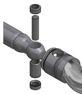
**Maintenance :** La série RL est conçue pour garantir une maintenance facile en réduisant au minimum le nombre de composantes à remplacer. En particulier, les douilles de l'articulation permettent la remise en état de celle-ci sans devoir remplacer les arbres et les rotors. Les coûts de maintenance sont ainsi réduits. Le coût de la machine, si l'on considère l'ensemble de sa vie, s'avère être très compétitif.
