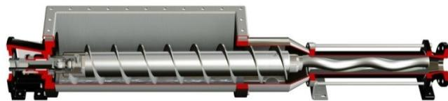
Version à trémie rectangulaire, avec protection des articulations et large vis d'Archimède d'alimentation vers la partie hydraulique. Adaptée au pompage de substances qui s'écoulent mal comprenant jusqu'à 28% de substance sèche à haute viscosité et qui n'ont pas tendance à former des ponts.
