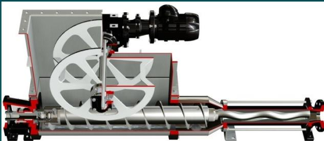
Version dotée d'une trémie rectangulaire, avec protection des articulations et large vis d'Archimède d'alimentation vers la partie hydraulique. Sur la trémie est installé le Module "B" qui, grâce à un dispositif à roue, alimente la vis d'Archimède en évitant la formation du pont. Adaptée au pompage de substances qui ne s'écoulent pas comprenant jusqu'à 40% de substance sèche et qui ont tendance à former des ponts et à être modelable.
