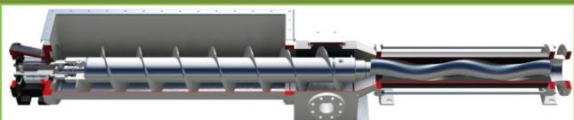
Version à trémie rectangulaire, avec protection des articulations et large vis d'Archimède d'alimentation vers la partie hydraulique, réalisée pour le secteur du biogaz en vue du pompage d'ensilage. L'embouchure séparée présente un raccord pour l'injection et un fond rectangulaire pour la collecte des graviers qui peuvent entrer dans la trémie, avec une grande trappe d'inspection supplémentaire.
