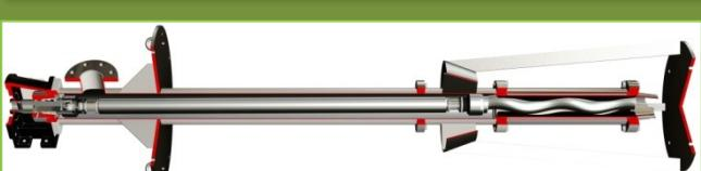
Série Verticale développée pour le pompage de citernes ou de puits immergée directement dans le produit à pomper. On peut totalement personnaliser la longueur. La version en acier inoxydable (AISI 304 ou AISI 316) est dotée de série d'une chemise de protection du stator pour en éviter la corrosion. Il existe deux configurations standards : une version courte et une version longue avec embouchure démontable et chevalet de fond de puits.
