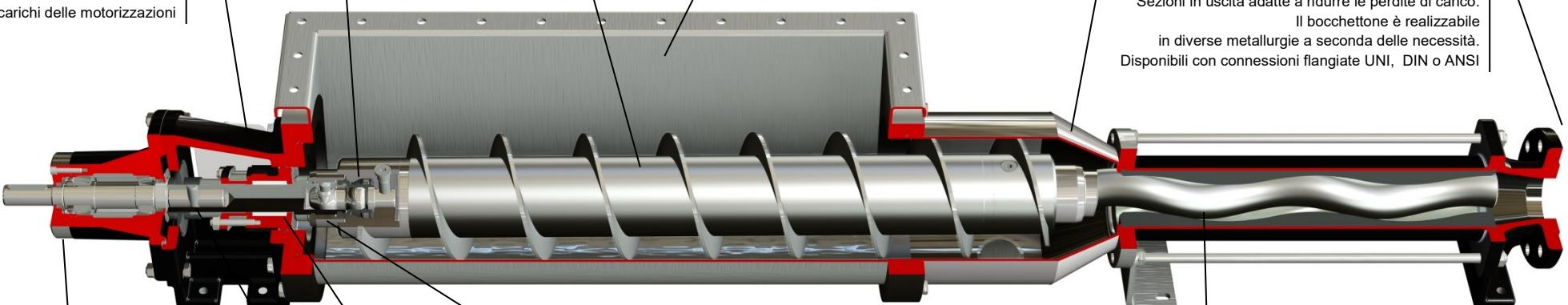
Protezione del giunto integrata all'estremità della coclea. Fondamentale per il pompaggio di fluidi abrasivi o contenenti solidi contundenti. Garantisce un notevole aumento di affidabilità del giunto
