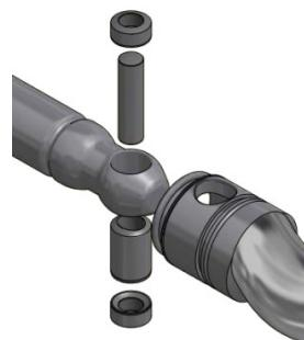
**Manutenzione:** La serie Diamond è progettata per garantire una facile manutenzione rendendo necessaria la sostituzione di un minimo numero di componenti. In particolare le bussole dello snodo consentono il ripristino totale dello stesso senza dover sostituire alberi e rotori. I costi di manutenzione risultano così ridotti. Il costo della macchina, considerato nel suo intero ciclo di vita, risulta essere altamente competitivo.
