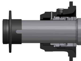
**Protezione del giunto:** Nella serie DHS e JHS il manicotto del giunto e la fascetta sono protetti da un particolare componente integrato alle estremità della coclea. Tale caratteristica è di notevole importanza in quanto garantisce l'integrità del giunto nel caso di pompaggio di sostanze abrasive o con solidi contundenti, senza la necessità di aggiungere costosi componenti opzionali.
