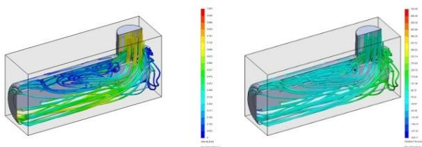
**Calcoli FEM:** i componenti strutturali delle pompe sanitarie serie X sono stati progettati utilizzando il calcolo di elementi finiti FEM. Sono state raffinate geometrie idonee per ottimizzare i pesi e i costi di ogni componente.
