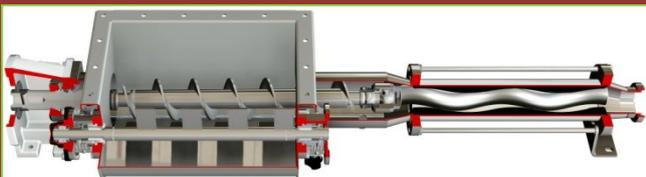
Versione dotata di tramoggia larga e coclea in alimentazione per la parte idraulica, ideale per il trasporto di prodotti poco scorrevoli con tendenza alla formazione del ponte. Realizzata di serie in acciaio inossidabile AISI 304 o AISI 316.
