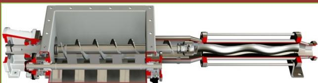
Versione dotata di tramoggia larga e coclea in alimentazione per la parte idraulica, ideale per il trasporto di prodotti poco scorrevoli con tendenza alla formazione del ponte. Realizzata di serie in acciaio inossidabile AISI 304 o AISI 316.
