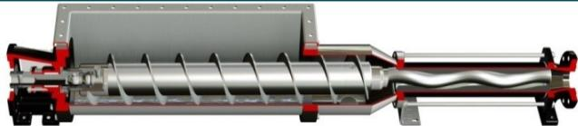
Versione a tramoggia rettangolare, con protezione degli snodi e coclea larga in alimentazione alla parte idraulica. Adatta al pompaggio di sostanze poco scorrevoli fino al 28% di sostanza secca ad alta viscosità che non tendono a formare ponte.
