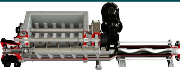
Versione dotata di tramoggia con doppio albero rompispina, con protezione degli snodi e coclea maggiorata in alimentazione alla parte idraulica. Adatta al pompaggio di sostanze non scorrevoli fino al 35% di sostanza secca ad altissima viscosità che tendono a formare ponte o in blocchi.
