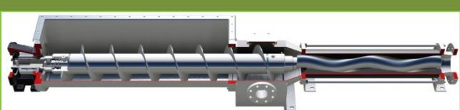
Versione a tramoggia rettangolare, con protezione degli snodi e coclea larga in alimentazione della parte idraulica realizzata per il settore biogas per il pompaggio di insilati. L'imbocco separato presenta la connessione per l'iniezione e un fondo rettangolare per la raccolta di sassi e altri corpi estranei che possono entrare nella tramoggia, con un ampio portello di ispezione supplementare.
