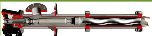
Serie Verticale sviluppata per il pompaggio da cisterne o pozzi immersa direttamente nel prodotto da pompare. La lunghezza è totalmente customizzabile. La versione in acciaio inossidabile (AISI 304 o AISI 316) presenta una camicia copri statore di serie per evitarne la corrosione. Esistono due configugazioni standard: in versione corta e in versione lunga con imbocco smontabile e cavalletto fondo pozzo.
