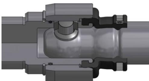
**Junta cardan:** A junta universal é a melhor solução em aplicações pesadas e de alta pressão dentro da carcaça da bomba. Permite aumentar o torque permitido em até 4 vezes para o mesmo tamanho de bomba. Está disponível com juntas metálicas protetoras internas para melhorar ainda mais a vida útil da borracha.
