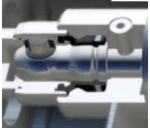
Proteção conjunta integrada no final da cóclea. Fundamental para bombeamento fluidos abrasivos ou fluidos contendo sólidos rombos. Garante um aumento significativo na confiabilidade conjunta
