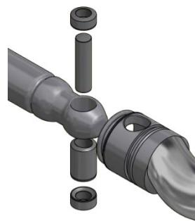
**Manutenção:** A série Diamond foi projetada para garantir fácil manutenção, exigindo a substituição de um número mínimo de componentes. Em particular, as buchas articuladas permitem a sua restauração total sem a necessidade de substituição de eixos e rotores. Os custos de manutenção são assim reduzidos. O custo da máquina, considerado ao longo de todo o seu ciclo de vida, é altamente competitivo.
