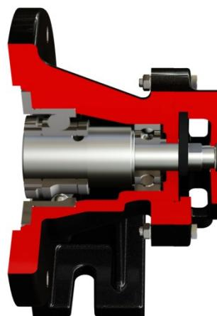
Motor elétrico integrado para a construção da bomba. O acoplamento é direto.
