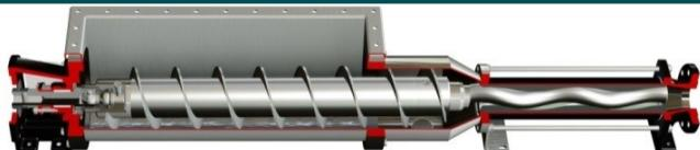
Modelo com funil retangular, com manga de proteção da junta e parafuso transportador alargado para conduzir o produto até a parte hidráulica. Adequado para bombear materiais de alta viscosidade, com baixa fluidez e até 28% de sólidos, não propensos à formação de pontes.
