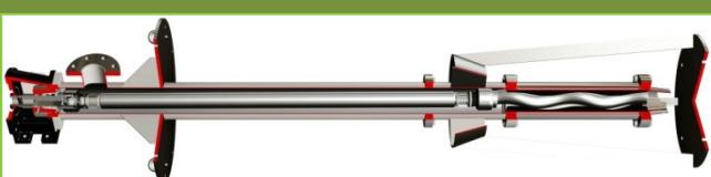
Série Vertical desenvolvida para bombeamento a partir de tanques ou poços imersos diretamente no produto a ser bombeado. O comprimento é totalmente personalizável. A versão em aço inoxidável (AISI 304 ou AISI 316) possui uma camisa de cobertura do estator como padrão para evitar corrosão. Existem duas configurações padrão: versão curta e versão longa com entrada removível e suporte de fundo de poço.
