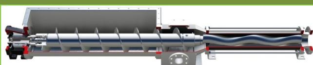
Versão moega retangular, com proteção de juntas e rosca larga alimentando a parte hidráulica criada para o setor de biogás para bombeamento de silagem. A entrada separada possui conexão de injeção e fundo retangular para coleta de pedras e outros corpos estranhos que possam entrar na moega, com grande portinhola de inspeção adicional.
